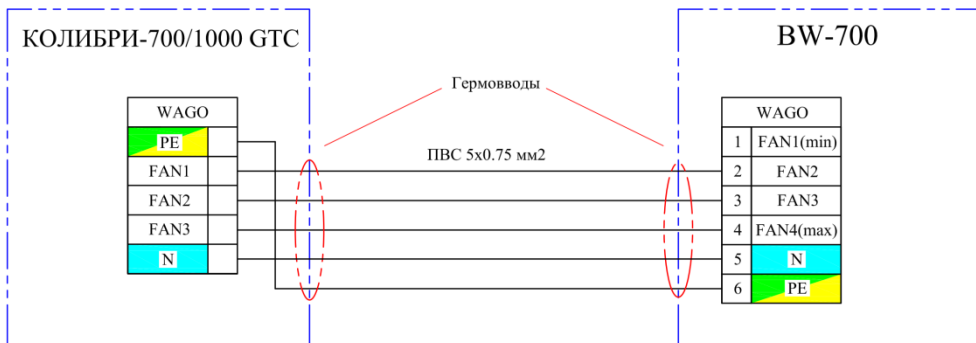
Схема подключения вытяжного блока BW-700 к ПВУ-350/500 GTC
